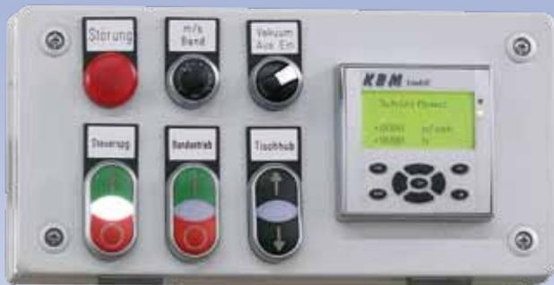
Bedienpult mit den Hauptfunktionen in der Maschinenmitte angeordnet. Display zur Anzeige der eingestellten Bandgeschwindigkeit und Fehlermeldungen.
