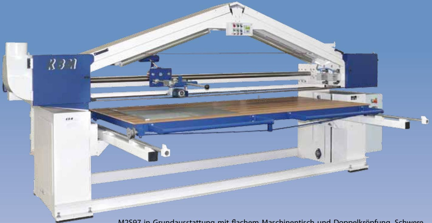
M2S97 in Grundausstattung mit flachem Maschinentisch und Doppelkröpfung. Schwere Maschinenausführung bis Schleiflänge 5000 mm lieferbar. Elektrische Tischhöhenverstellung durch zwei synchron gesteuerte Getriebemotoren. Die unteren Verbindungsprofile können nach der Maschineninstallation entfernt werden.
