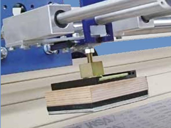
Schleifschuh mit Kugelschnellklemmung.
