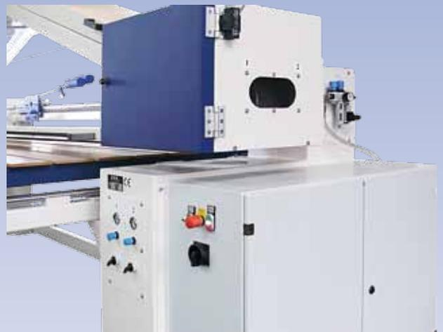
Rechter Maschinenständer mit Kröpfung, Schalter und Druckregler für pneumatische Bandspannung. Von vorn bedienbar.
