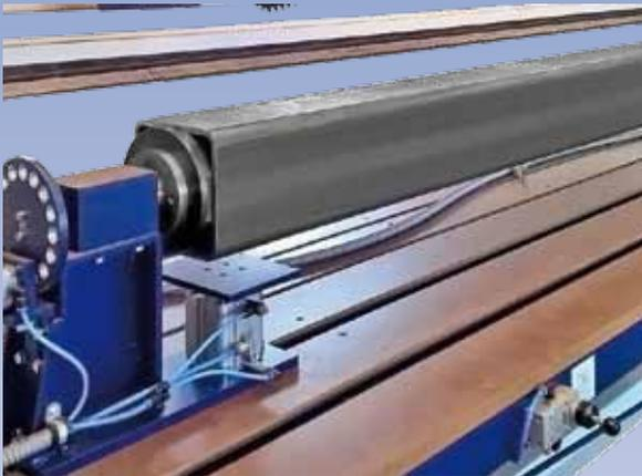
Werkstückspann- und Drehvorrichtung auf dem Maschinentisch montiert, pneumatisch bestätigt.
