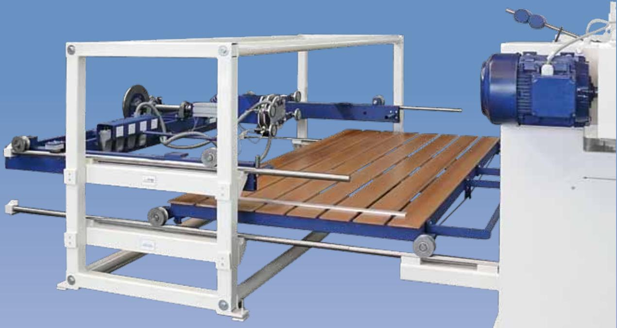
Zweiter Maschinentisch mit 3D-Werkstückhandlingvorrichtung und Lagergestell (Mehrpreis) hinter der Maschine aufgestellt zum Wechseln der Maschinentische.
