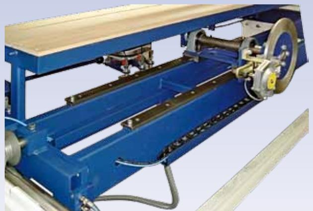
3D-Werkstück-Handlingvorrichtung über Führungen von der Tischmitte zur rechten Tischseite verschiebbar.
