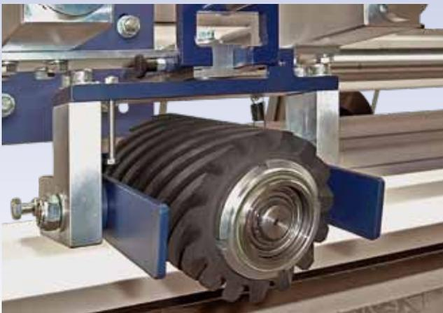
Die Kontaktrolle ist mit einer Steckvorrichtung ausgestattet und kann ohne Werkzeug gegen einen Schleifschuh getauscht werden.
