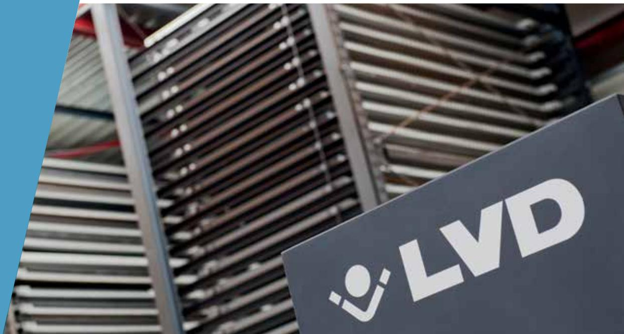
El Sistema de Automatización del Almacén MOVit WAS ofrece lo último en el almacenamiento y recuperación automáticos del material con un número personalizable de unidades de almacenamiento de torres, a partir de un mínimo de cuatro torres, en una configuración de una o doble fila. WAS mantiene las chapas en flujo continuo para una producción ininterrumpida y para un funcionamiento desatendido y se puede conectar a múltiples máquinas de corte por láser en formatos de 3015 o 4020.
