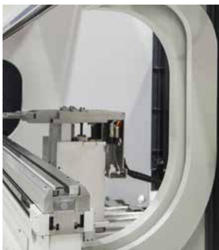
Aumenta la distancia mesa-trancha/carrera de trabajo/cuello de cisne en paso de 100 mm
