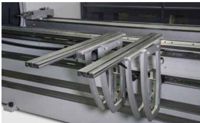
Los carriles guía funcionan como soportes delanteros que permiten una rápida colocación de la chapa a lo largo de la máquina.
